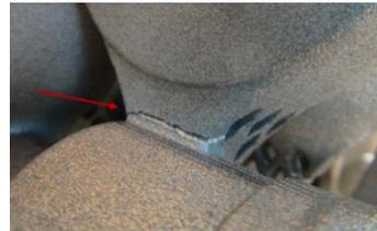
Exemple de macro-fissure sur une pièce en LBM apparue au cours de la fabrication
