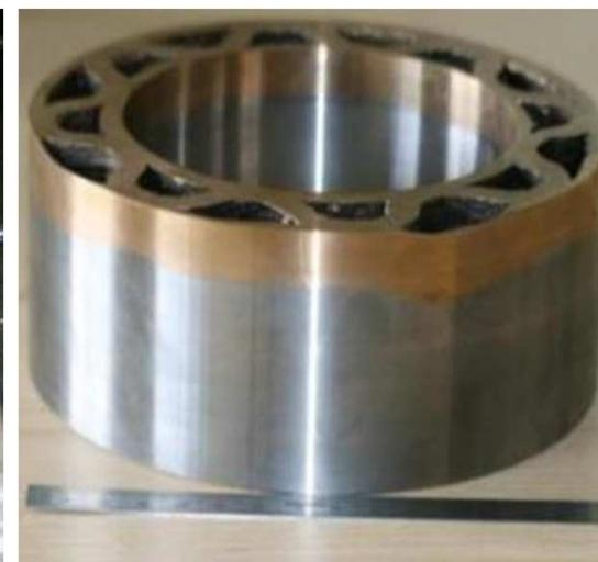
*Pièce bimétallique (acier et alliage de Cu)*
