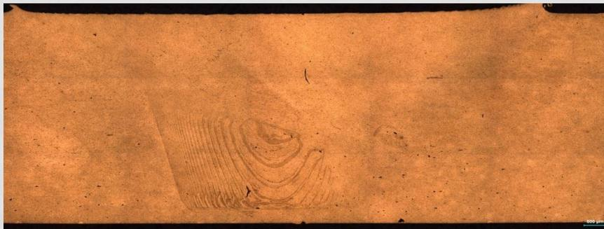
Figure 2. structure "onion rings" expérimentale
