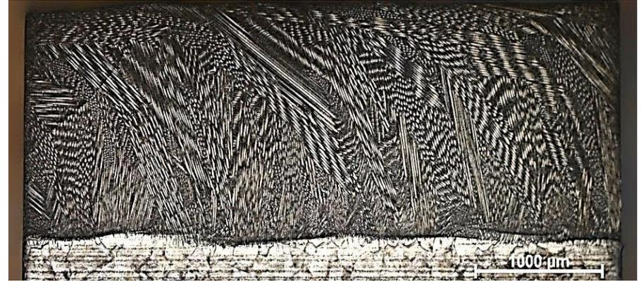
Microscopie optique A600 vs FM 52 mode longitudinale
