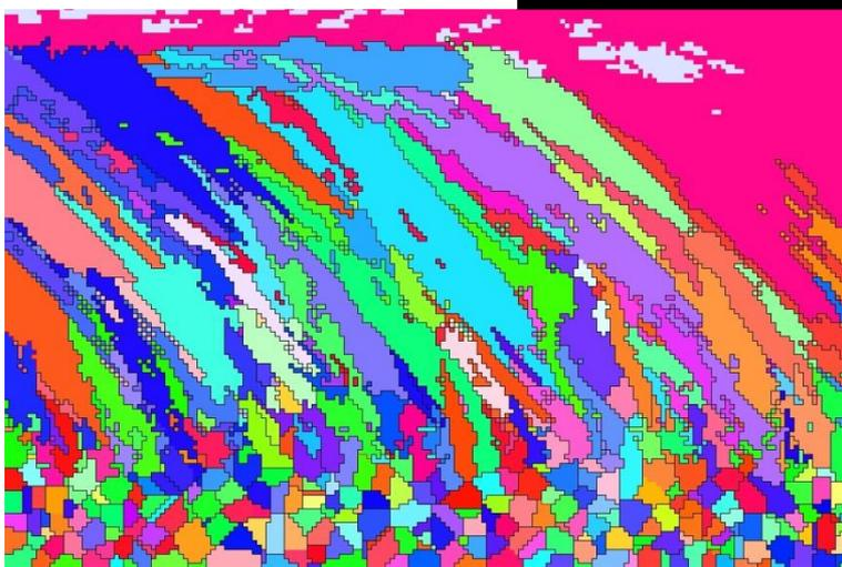
Reconstruction EBSD de la coupe 2D longitudinale de la simulation du cas test
