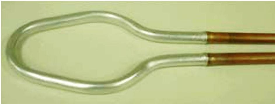
Assemblage hétérogène Cu/al : tubes de compresseur, remplacement de 100% Cu par 2/3 Al + 1/3 Cu (soudure MPW).
