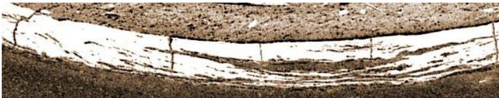
Assemblage hétérogène aluminium sur acier (soudage FSW par point) : alliage d'aluminium 6008 : 40 HV ; acier : 220 HV ; bande d'intermétalliques ( $\text{FeAl}$ ,  $\text{Fe}_2\text{Al}$ ,  $\text{Fe}_2\text{Al}_7$ ) : 520 HV.
