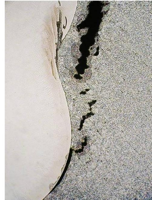
Rupture d'un assemblage entre un acier ferritique et austénitique, côté acier ferritique. Document David N. French Metallurgists
