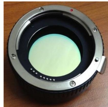
Filtre Passe-Bande pour  $420 \text{ nm} \leq \lambda \leq 460 \text{ nm}$
