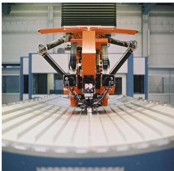
Figure 1 : Soudage laser d'un panneau de fuselage (Premium Aerotec)
