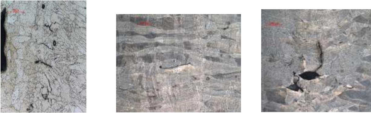
Figure 2 : Différents types de fissures observables en fabrication additive par Laser Beam Melting
