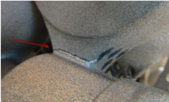
Figure 4 : Exemple de macro-fissure sur une pièce en LBM apparue au cours de la fabrication
