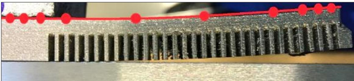
Figure 5 : Déformation d'une pièce en LBM due aux fortes contraintes résiduelles
