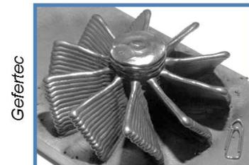
Les verrous technologiques à lever sont nombreux avant d'utiliser la FA arc-fil en production. Outre la disponibilité de logiciels permettant de passer d'un fichier CAO à un programme de robot polyarticulé, il faut pouvoir disposer de moyens de monitoring. Il est également difficile de prédire les déformations des pièces et bien entendu un alliage non soudable (par exemple la majorité des superalliages base Ni) ne peut pas être mis en œuvre en FA.
