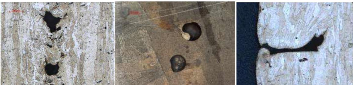
Figure 1 : Porosités type manque matière (a), soufflures (b) ou manque de fusion (c) en coupe micrographique
